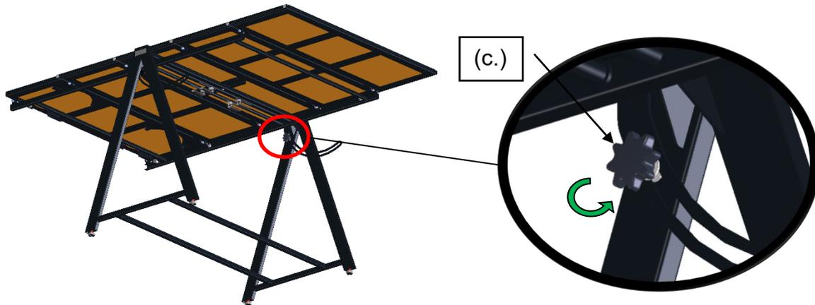
Bei der Tischvariante müssen die beiden Hochsteller immer in Stützposition verriegelt sein. (Im 45° Winkel nach unten – Bilder Seite 8)
