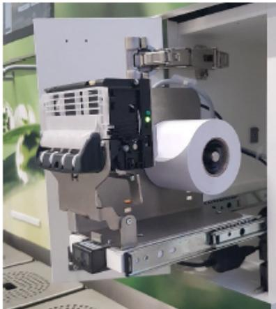
3. Öffnen Sie die Druckerblende und ziehen Sie die Druckereinheit zu sich heraus.
