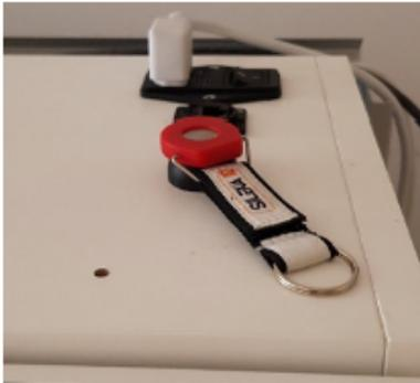
1. Öffnen Sie das Bedienermenü durch das Auflegen des Schlüssels.
