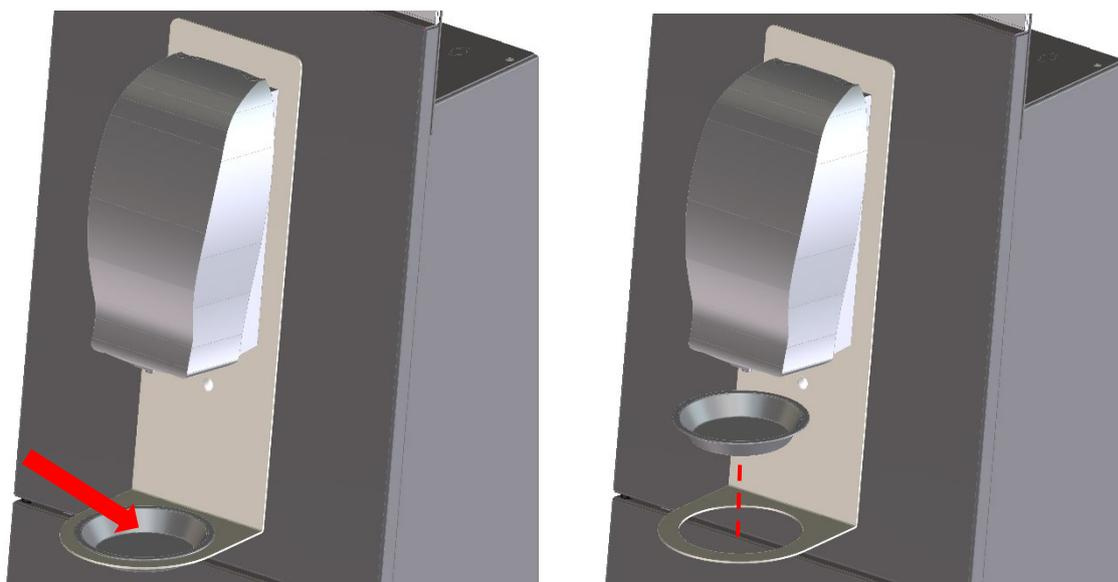
**Schritt 1:** Wischen Sie die herausnehmbare Abtropftasse regelmäßig aus.
