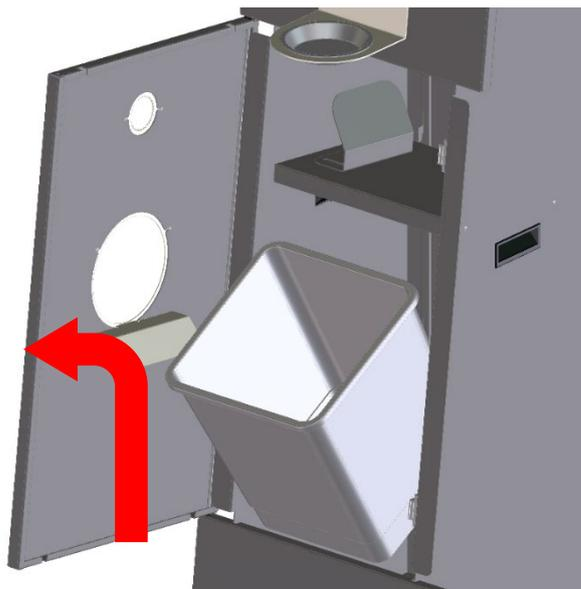
**Schritt 1:** Entnehmen Sie den Mülleimer zum Entleeren aus der Hygiene Station.
