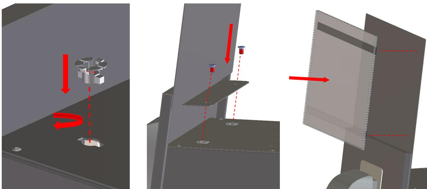
**Schritt 1:** Stecken Sie die Bajonettmutter in die Öffnung und fixieren Sie diese durch Verdrehen.
