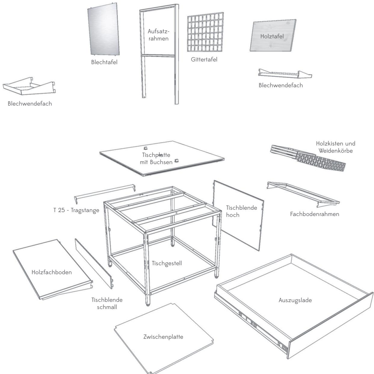
Der Varitable ist mit einem Aufsteckrahmen versehen – Die Integration von trendigen Kreidetafeln oder digitalen Head-up Displays ist damit möglich.
