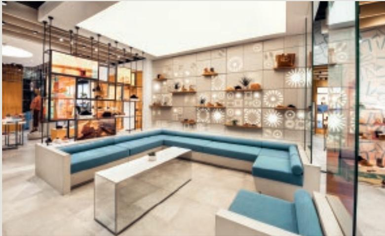
Das Highlight des neuen Ladenkonzepts verläuft entlang der Wand in der Mitte des Ladens. Das als „Poolwand“ bezeichnete Element ist mit ausgesägten Lichtöffnungen versehen, die in ihrer Form an kleine Wellen, Sonnenstrahlen oder Schneeflocken erinnern und von einem verborgenen Leuchtkasten hinter der Sperrholzwand beleuchtet werden.
